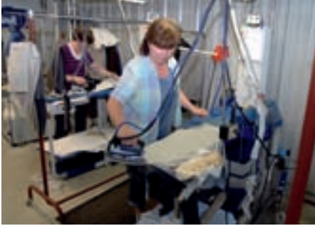
Finishbereich im Norge-Zentralbetrieb: Nur die Teile für die Annahmestellen werden „endgefinishet“, die Kleidung für die Filialen wird nur vorgetoppt.
